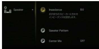
●写真4: スピーカー設定(マニュアル)の設定画面。接続するスピーカーのインピーダンスなどを設定できる
