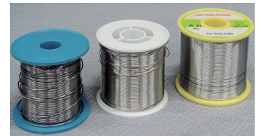
●写真4: ソニーのオーディオ機器に採用されたはんだ。左から有鉛はんだ、無鉛はんだ、高音質無鉛はんだ
