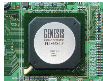
●写真1: 映像処理用LSIに採用されたGENESIS社の「FLI8668-LF」
