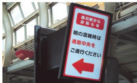
設置箇所上部には窓があり、GXD-L65H1の防塵・防滴仕様が有効
