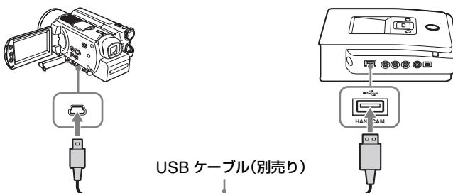
USB ケーブルをつなぐと、“ハンディカム”的液晶画面に〔USB 機能選択〕が表示されます。
