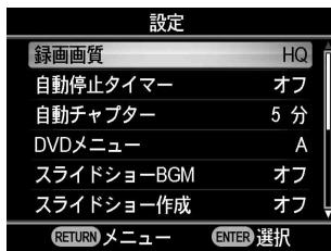
**4** ↑/↓を押してカーソルを動かし、確認・変更したい項目を選び、□(選択)ボタンを押す。
