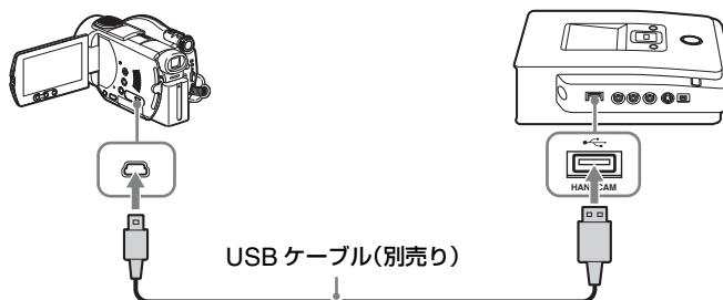
USB ケーブルをつなぐと、“ハンディカム”的液晶画面に[USB 機能選択]が表示されます。
