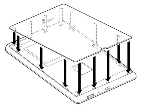
本機裏面上部の穴(4箇所)に、バックパネルの突起部分を挿入して、バックパネルを閉めます。 すべての突起部分を Readerの取り付け穴(図の矢印の方向)にはめこみ、しっかりと押して取り付けてください。
