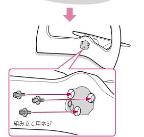
電動ドライバーを使う場合は、締め付けトルクを約1.5 N・m[15 kgf・cm]に設定してください。
