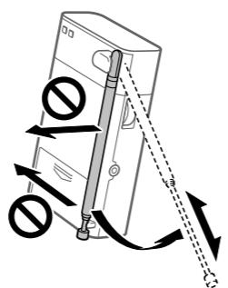
FMアンテナを長く伸ばして、受信状態の良い方向を探してください。
