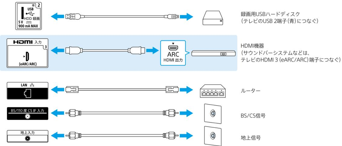
有料放送を含むすべてのBS4K放送と110度CS4K放送を視聴するためには、4K放送(左旋放送)に対応した衛星アンテナと分配器やブースター、分波器、F型接柱の同軸ケーブルなどの受信システム機器(3224 MHz対応)が必要です。詳しくは、取扱説明書をご覧ください。また、設置後にアンテナレベルが受信可能レベルに達しているかどうかを確認してください。
