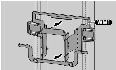
**9** WM5を取り付ける(壁掛けブラケット取り付け穴の間隔が400 mmの場合のみ)。
