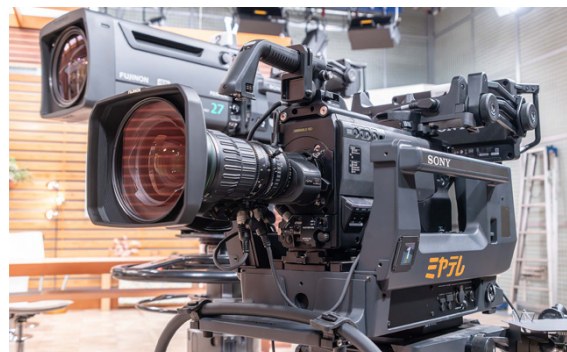
ハンガーマウントを取りはずし、ポータブルレンズで運用
