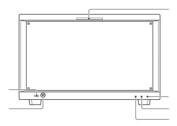
タリーランプ OPERATE(操作)ランプ STATUS(ステータス)ランプ OVER RANGE(オーバーレンジ)ランプ OPTION A(オプションA)端子 OPTION B(オプションB)端子
