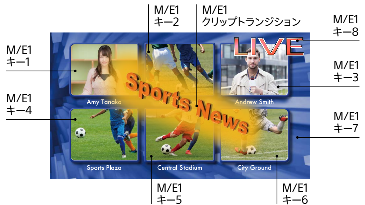
M/E1 出力映像例 (HD) : 8 キーヤー＋クリップトランジション
