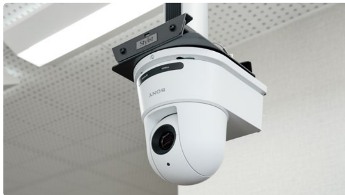
オンラインでも講師と視線が合う高さに設置されたリモートカメラシステム『SRG-A12』
