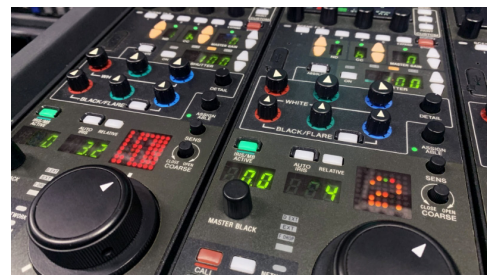
BRC-AM7 との連携に対応する リモートコントロールパネル『RCP-3501』
