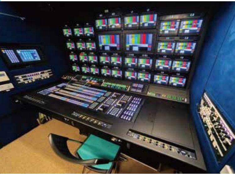
スイッチャー操作卓。メニューパネルを側面壁に埋め込むなどの工夫でスペースを確保
